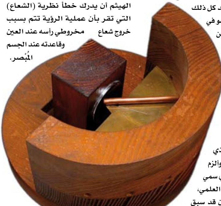
(آلة الانعكاس) التي استخدمها ابن الهيثم للتحقق من قانون الانعكاس في مختلف الأوضاع
