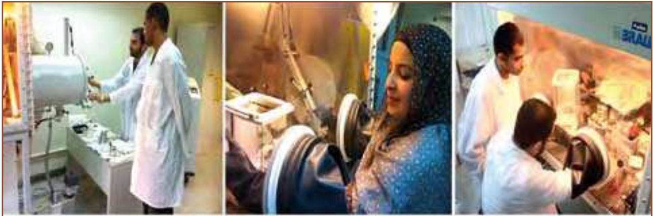
صور مجمعة أخذت لتبين مراحل تحضير حبيبات هيدريد المغنيسيوم النانوية ومتراكباتها وذلك في مختبرات تكنولوجيا النانو التابعة لمركز أبحاث الطاقة والبناء بمعهد الكويت للأبحاث العلمية. وقد تم اتباع أسلوب تقنية الطحن التفاعلي تحت جو من غاز الهيدروجين. وقد تم التعامل مع تلك الحبيبات النانوية المنتجة في جو من غاز الأرجون الخامل داخل صندوق القفازات. وقد بلغت مقاييس أطوال أقطار الحبيبات المخلقة نحو خمسة نانومترات (النانومتر الواحد يعادل جزءاً من مليار من المتر الطولي)
