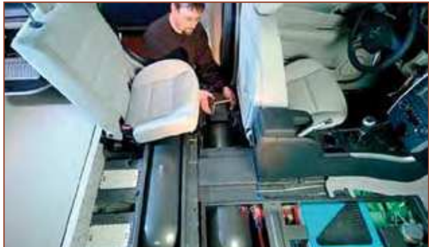
تمثل تقنية ضغط غاز الهيدروجين تحت ضغوط عالية تراوح قيمها بين 200 - 350 ضغط جو وتعبئته في أسطوانات ذات جدران سمكية أسفل مقاعد رواد المركبات خطورة بالغة على حياتهم وذلك لانخفاض عنصر الأمان أثناء تسير المركبة هذا علاوة على أن استخدام أسطوانات سمكية الجدران استيعاب الهيدروجين المضغوط تحت تلك القيم العالية، يمثل وزناً إضافياً وعيباً على محرك المركبة مما يؤدي إلى زيادة في معدل استهلاك الوقود الهيدروجيني
