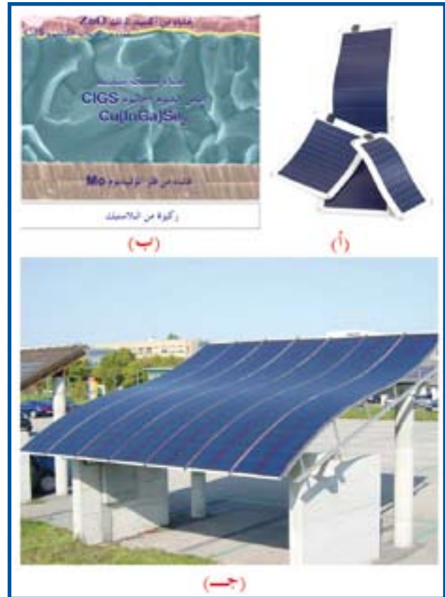
الشكل (3): يمثل الشكل (i) نماذج من خلايا الجيل الثاني الكهروضوئية التي تتمتع بليونة عالية. ويبين الشكل (ب) صورة ملتقطة بواسطة المجهر الماسح الإلكتروني لقطاع رأسي من تلك الخلية يبين تركيب طبقاتها وترتيبها. وتعرض الصورة في (ج) نموذجاً من وحدات تلك الخلية وتم عرضه لبيان مدى ليونته وسهولة استخدامه.
