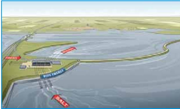
الصورة توضح كيفية تنفيذ الفكرة في الطبيعة ، حيث توجد أنابيب للمياه العذبة fresh، وأخرى لمرور المياه المالحة Salt، والجانبان معزولان بمبنى خاص يحتوي على نظام الأغشية الخاص لفصل الشحنات وتوليد الكهرباء
