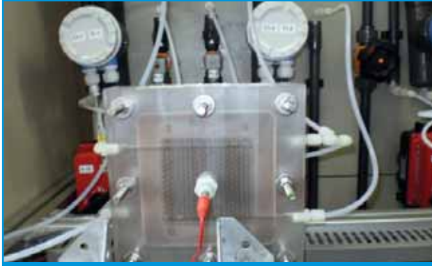
صورة لأحد الأغشية المستخدمة في المختبر لتكوين الطاقة الزرقاء عن طريق فصل الشحنات الكهربائية
