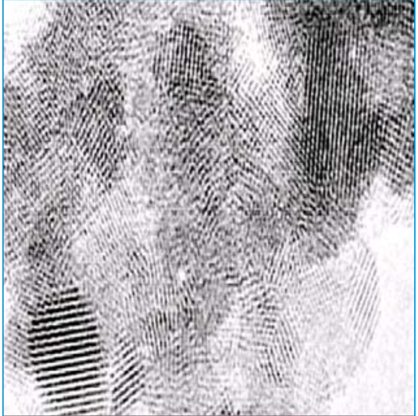
صورة بواسطة المجهر (الميكروسكوب) الإلكتروني النافذ العالي الدقة لجزء من أداة حفر توضح تركيبها الداخلي المؤلف من عدة حببيات نانوية الحجم لا تتعدى أقطارها 5 نانومترات. ويوضح الشكل وجود معظم ذرات المادة على الحدود الخارجية للحببيات مما كان له سبب رئيسي في تمتعها بخواص ميكانيكية متميزة لا توجد في نظيرتها من المواد المؤلفة من حببيات كبيرة
