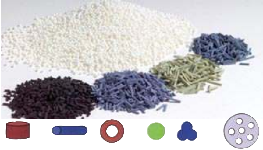
الشكل (1): أشكال ومقاطع مختلفة لمواد حفازة تستخدم في صناعة تكرير النفط والصناعات الكيماوية
