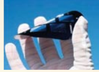
الشكل (5): مكَّنت التقانات الحديثة للأفلام الرقيقة (الرُقاقات) من تطوير خلايا شمسية مرنة ونصف شفافة وبسماكة لا تتجاوز بضع عشرات من الميكرومتر، يمكن استخدامها كبديل للواجهات الزجاجية.
