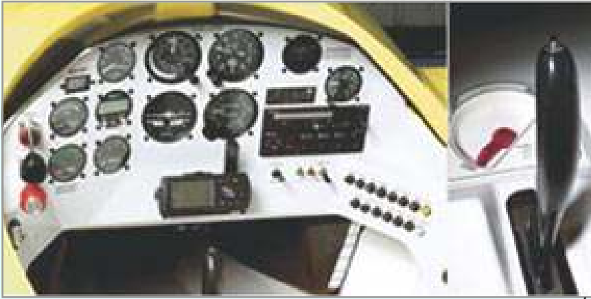
قمرة القيادة بدون طيار آلي، وعمود التحكم ليفكاريون رشيق، وسواعد الحركة والموصلات وقضبان الدفع باليد أيضاً.
